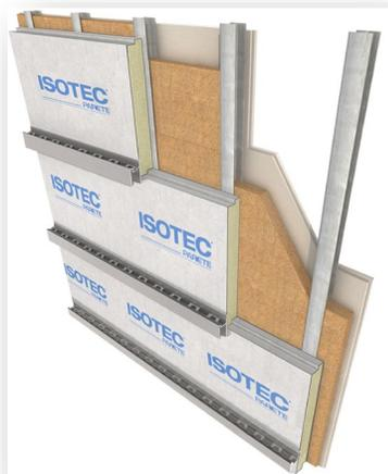
**Struttura discontinua in acciaio**
